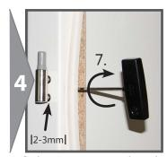
**Schritt 6:** Neues Türbandrahmenteil mit Bremsfunktion einsetzen. Zwischen Türrahmen und Türband einen Abstand von ca. 2-3mm einhalten. **Schritt 7:** Nun mit Inbusschlüssel die Klemmschraube in Drehrichtung **rechts** fest anziehen.
