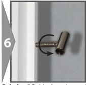
**Schritt 10:** Vorhandenes Flügelteil aus Türblatt in Drehrichtung <u>links</u> entfernen.
